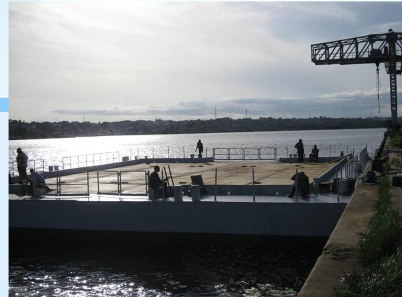
Dans le cadre de la construction du 3ème Pont à Abidjan Côte d'Ivoire, CIC Marine s'est vue attribuée par la SACPRM, filiale de Bouygues Construction, la construction de deux barges industrielles d'une capacité de charge en mouvement de 150 tonnes chacune.
